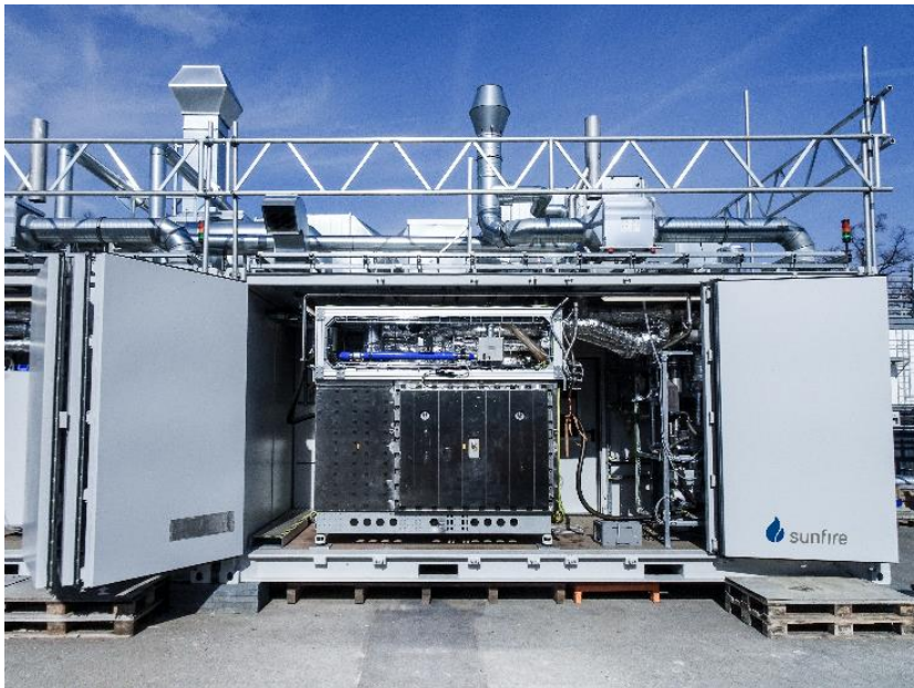
Sunfire Generation 2 SOEC-Modul (225 kW) © Sunfire GmbH
